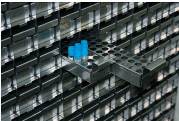
In diesen Schrankeinschüben zur Lagerung von 2ml Kryoröhrchen lagern die Röhrchen direkt in den Schubladen, gehalten von einem Locheinsatz – gemäß Kundenwunsch 3 Röhrchen nebeneinander je Schublade. Auf den Frontseiten der Schubladen ist eine Numerierung angebracht, damit jede Probe einwandfrei zugeordnet werden kann.
